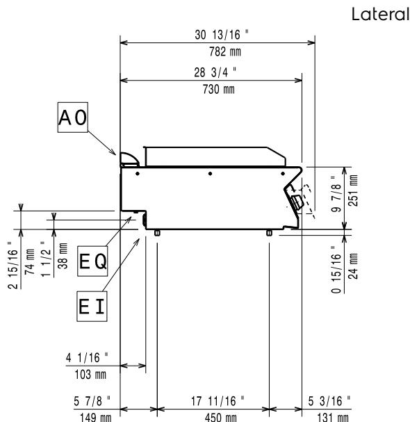
EI = Conexión eléctrica (energía)
